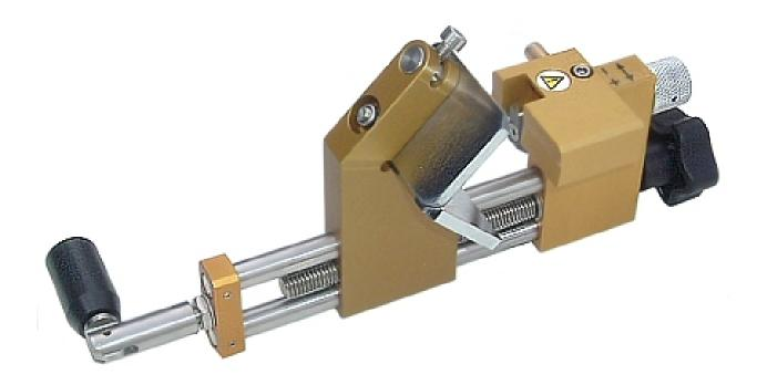
Einstellbare Schältiefe 0-1,2 mm mit 0,1 mm Feinabstufung Schälbeginn direkt am Kabelende Automatischer Arbeitsvorschub Zwei Vorschubwinkel, eine Nullstellung einstellbar
